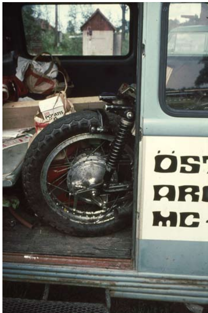
Resterna av Hars' Honda 750 med tre rambrott.
